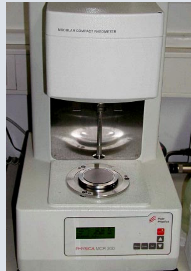
Bestimmung der dynamischen Viskosität mit Hilfe eines Kegel-Platte-Rheometer
